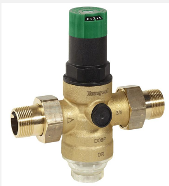
Foto 3: de drukregelaar. In werkelijkheid is dit toestel 20 cm breed en 15 cm hoog en wordt opgesteld in de lijn van de waterinstroom na de watermeter.
